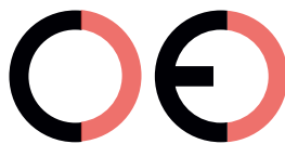
Marca CE falsa (demasiado separados)
